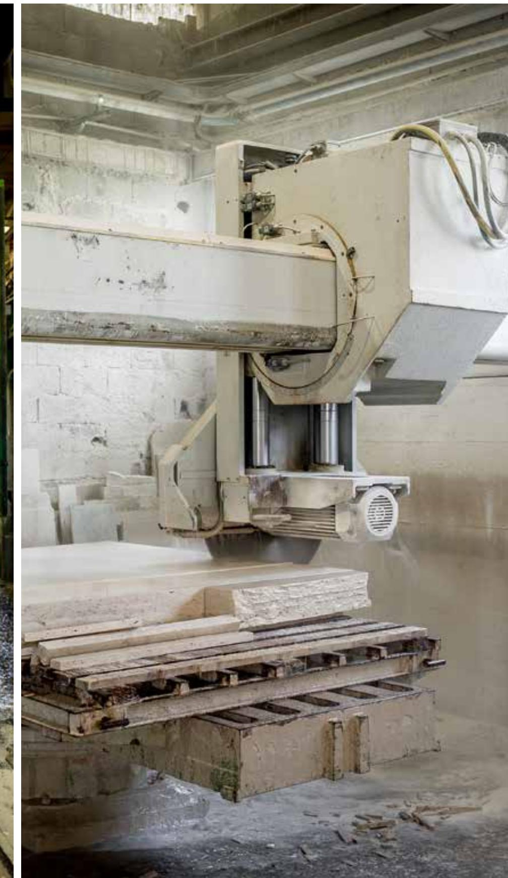
La nuova segheria Aretina Marmi è attrezzata con telai diamantati i quali permettono di assicurare una produzione di lastre in tutti gli spessori commerciali con l'elasticità e la dinamicità che sono richieste dal mercato di oggi. L'introduzione di un telaio monolama diamantato consente di squadrare i blocchi prima della segazione, permettendo così di ottenere lastre perfettamente riquadrate con un notevole risparmio di costi.
